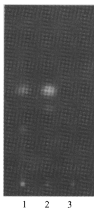
1. 样品; 2. 当归对照药材; 3. 缺当归阴性对照 图 1 泻肝安神丸中当归鉴别薄层色谱图
