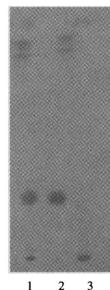
1. 样品; 2. 远志皂苷元对照品; 3. 缺远志阴性对照 图 4 泻肝安神丸中远志鉴别薄层色谱图
